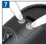
Druk de beide bedieningstoetsen gelijktijdig in en houd ze 3 seconden vast. De indicatielichtjes knipperen nu.
